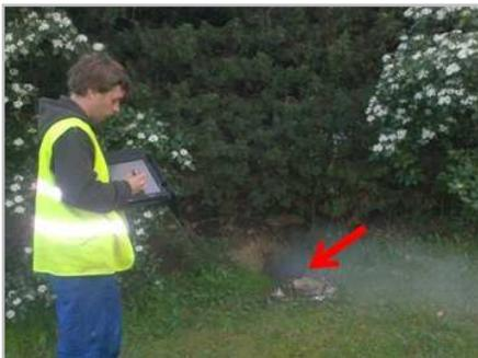
Point d'injection du fumigène et saisie informatique des anomalies observées sur le terrain
