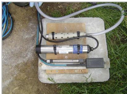
*Crépine de prélèvement, sondes de turbidité, de vitesse et piézométrique sur leur support*
